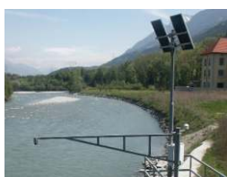
Medición de nivel de agua
