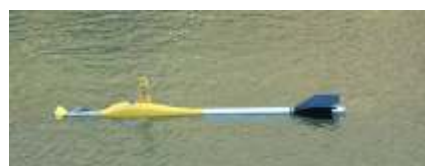
Mediciones con molinete tipo SEBA F1
